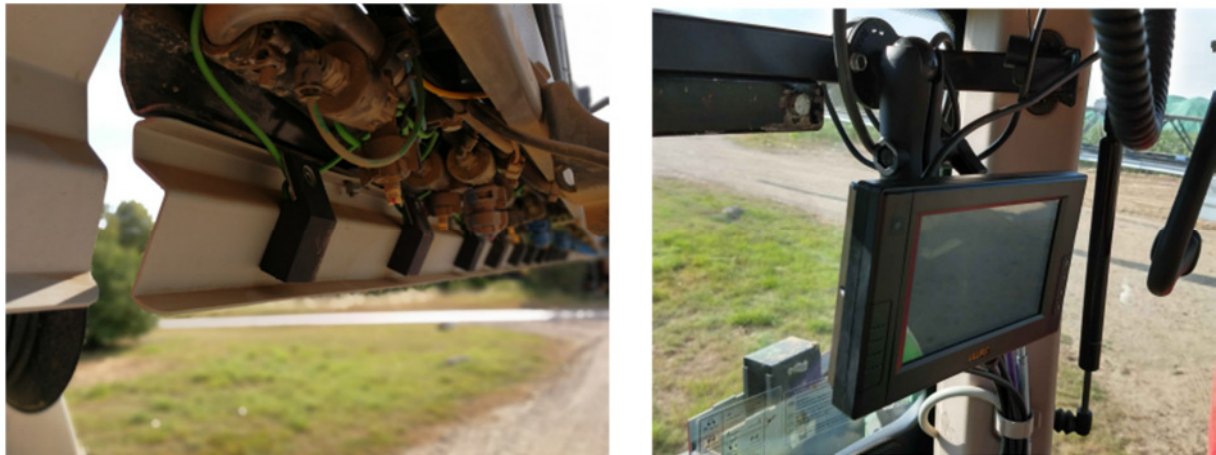
Bild 8: Anbringung der SprayRay Sensoren und des MSO SprayMon Bordcomputers
