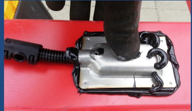
2. Platzieren Sie die Abdeckhaube über dem DMS Sensor und drücken diese leicht herunter – wobei Sie diese leicht seitlich hin und her bewegen – bis diese über dem DMS Sensor sitzt.
