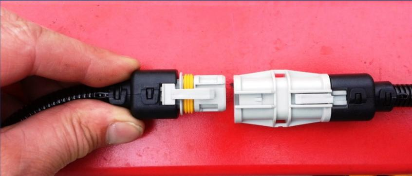
Schließen sie den Stecker MAN an die entsprechende Buchse an. Stellen Sie sicher, dass die Verbinder einrasten (klickt).
