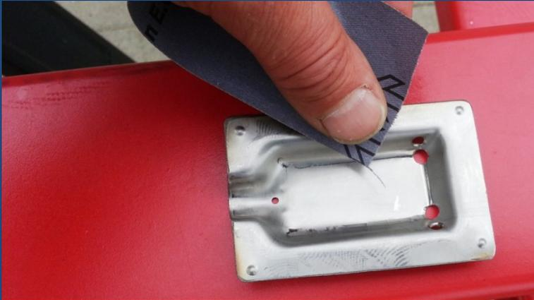
Schleifen Sie die inneren Kanten der DMS Abdeckhaube mit Schleifpapier
