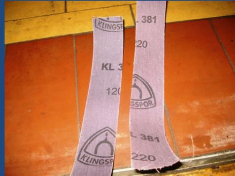
2. Reinigen Sie die Fläche mit Schleifpapier mit 120er, dann mit 240er Körnung
