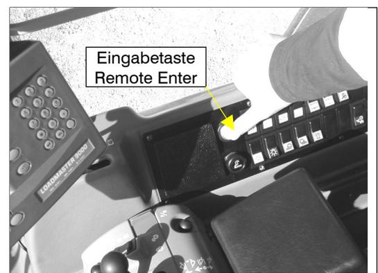
Abb. 9: Montage im Armaturenbrett (Volvo 150E)
