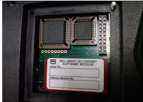
Abb. 30 : Anbringung des Softwaremoduls
