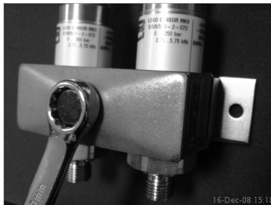
**Abb. 18b :** Montage des Lastsensor (Mk 9 Sensor)
