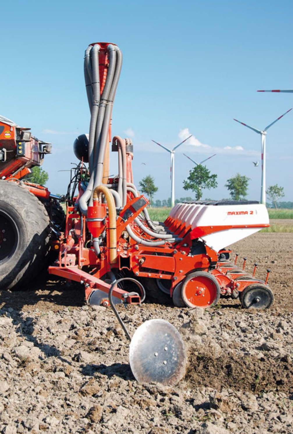
Auf die Überwachung der Vereinzelnung kann man sich beim Maislegen verlassen. Ob auch der Dünger sicher unter der Reihe landet, überwacht der „SeedMon“ von MSO.
