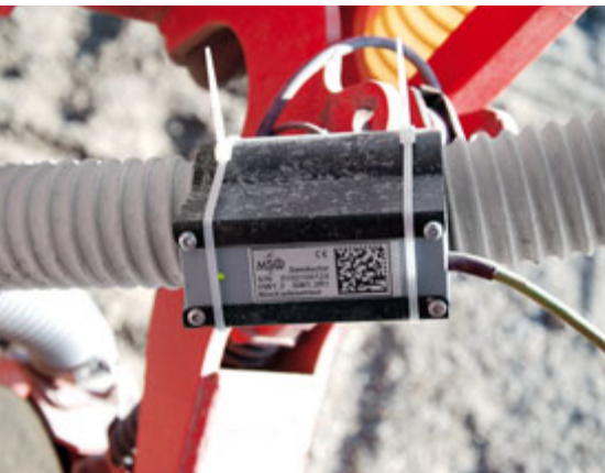
Der Sensor schickt Mikrowellen durch den Schlauch, die den Fluss erkennen.
